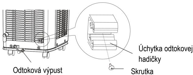
3. Nasadte odtokovú hadičku na odtokovú výpust a upevnite ju svorkou.
