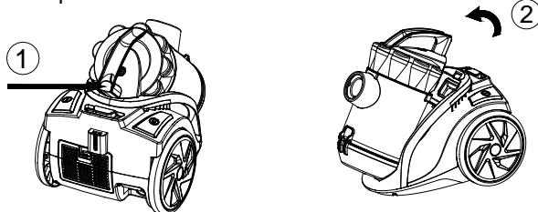
3. Nádobu držte nad odpadkovým košom a stlačením tlačidla (pozri obrázok č. 3) uvoľnite dno nádoby. Ľahkým zatrepáním uvoľnite všetky nečistoty. Potom nádobu uzavrite a vráťte späť do prístroja.
